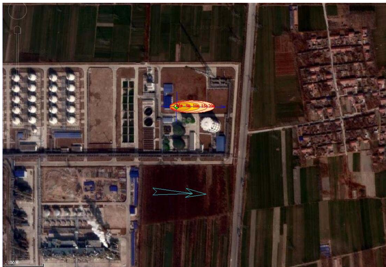
图 7.5-7 持续泄漏甲苯污染晕分布示意图
