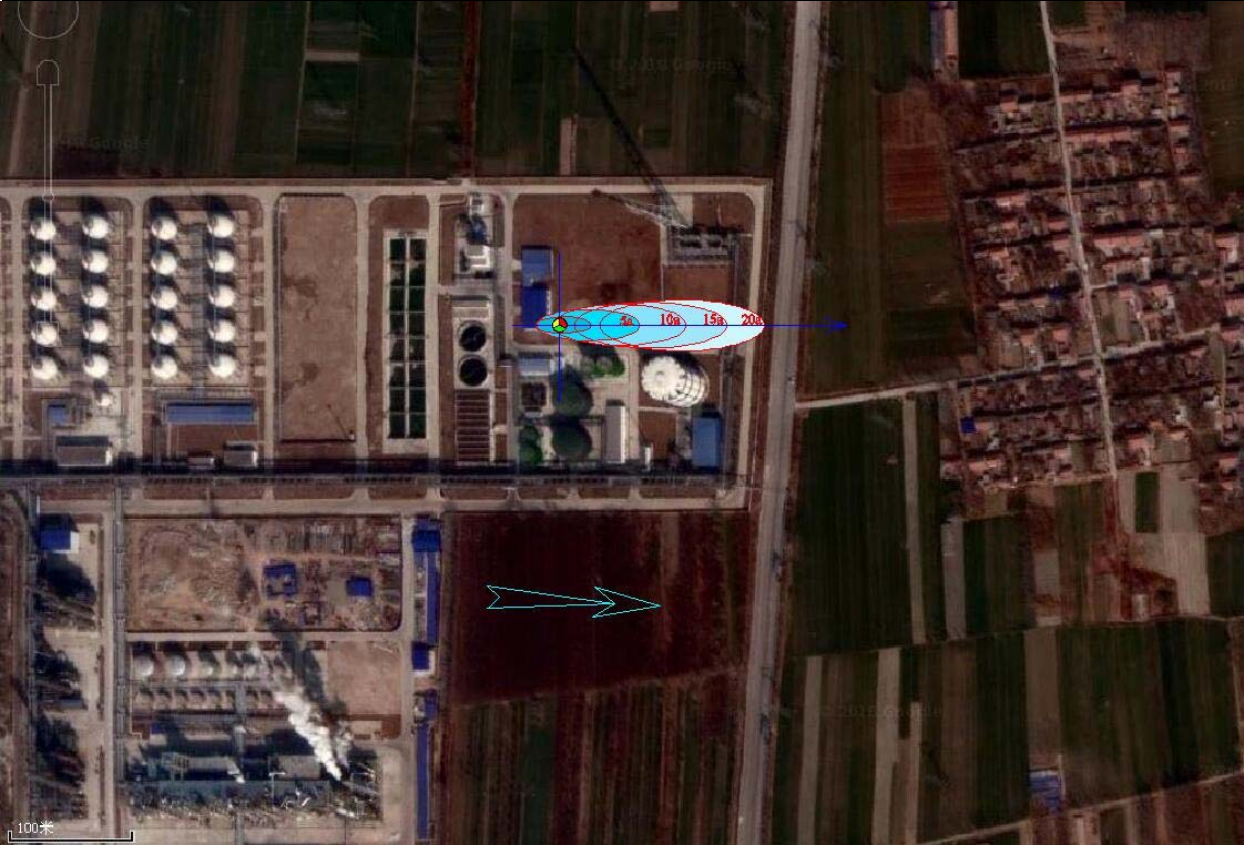
图 7.5-1 瞬时泄露 COD 污染晕分布示意图
